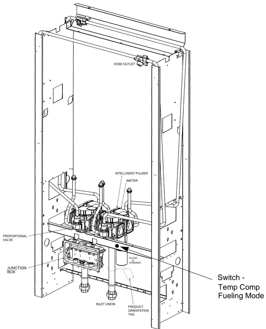
**FIGURE 6-2. TEMP COMP FUELING MODE SWITCH (CANADA ONLY).**
