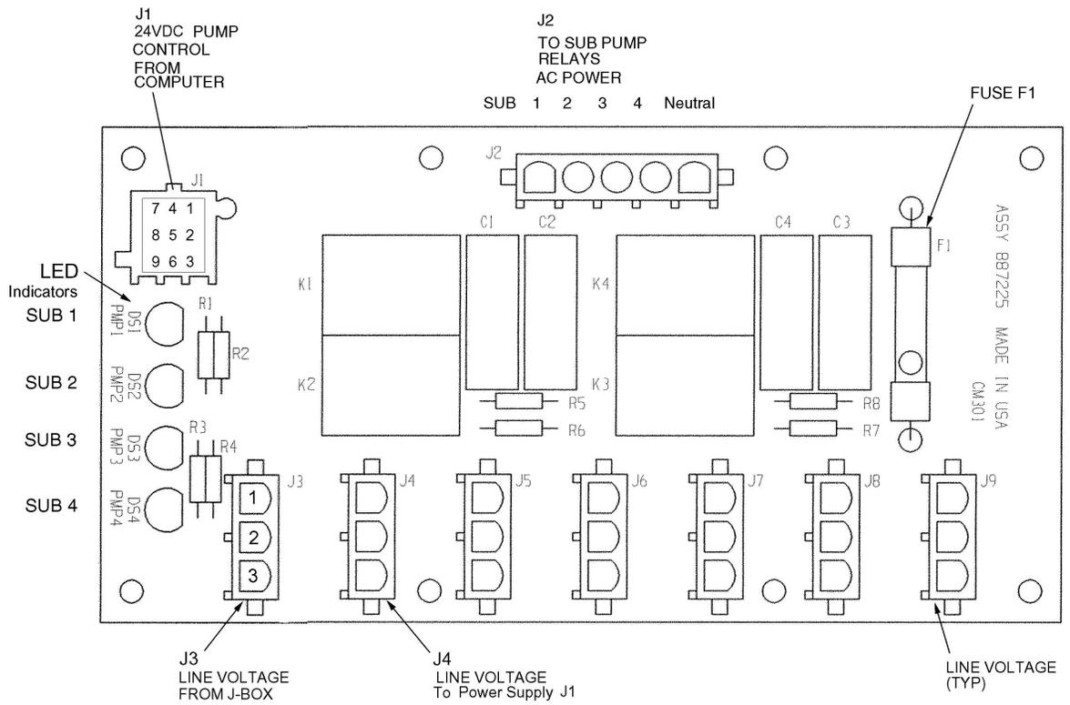
**FIGURE 9-4. RELAY BOARD.**
