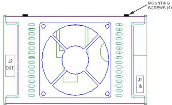
**FIGURE 9-7. POWER SUPPLY ASSEMBLY.**
